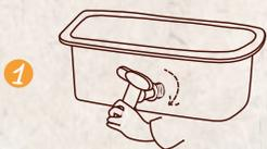
1 Vissez le robinet dans le trou du bac collecteur de liquide avec l'écrou, après avoir placé le joint d'étanchéité.
